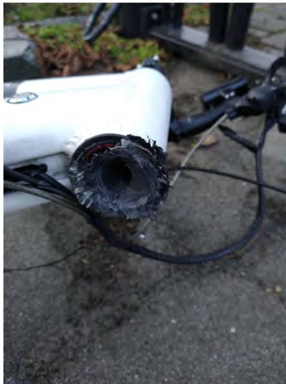
Carbongabelbruch bei Stromer ST1 2016, bricht spontan im Jahr 2021 (Foto: Forumsmitglied Robert Steady Speed)
