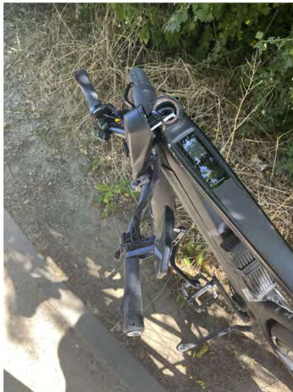
Stromer ST3 PINION mit Wren-Federgabel. 9 Monate alt, 4.000 km Laufleistung. Die Gabel brach während einer Fahrt spontan ab (Foto: Forummitglied HansN).
